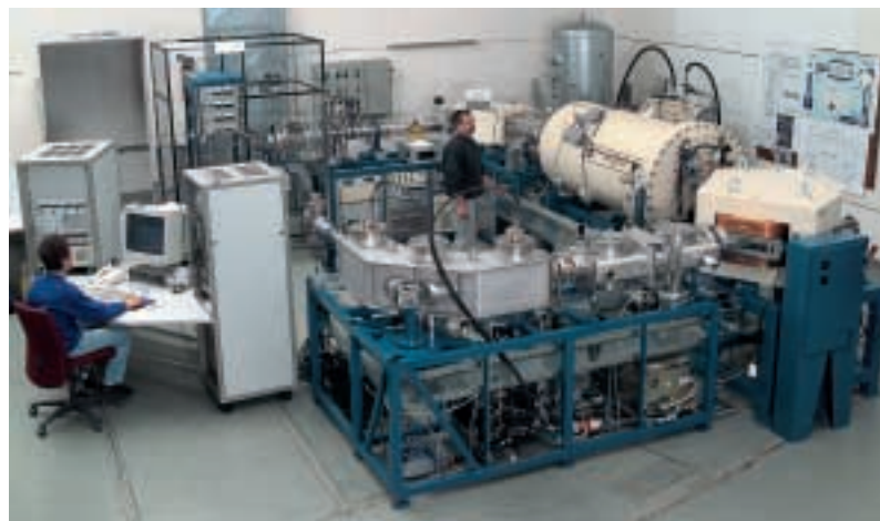
Abb. 2: Osteoporose-Forschung mit Hilfe der Teilchenphysik: Calcium-41-Nachweis im Urin mittels Beschleunigungs-Massenspektrometrie.
