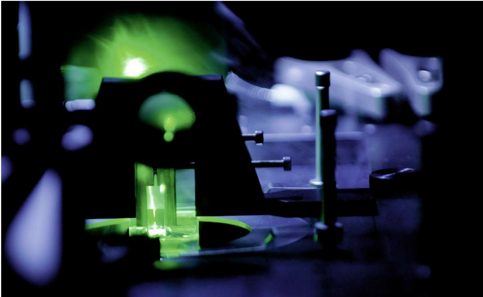
Leuchtende Moleküle: Der Laser macht Moleküle sichtbar, so kann ihre Bewegung und Faltung beobachtet werden.
